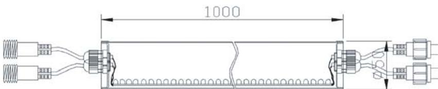
Труба имеет по 2 вывода проводов с каждой стороны. Провод черного цвета используется для подключения питания. Провод белого цвета используется для подключения к контролльному аппарату.
