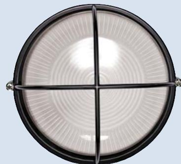
Светильники для ламп накаливания с цоколем E27 максимальной мощностью 60 Вт (НПБ 1308) и 100 Вт (НПБ 1108) и степенью защиты от воздействия окружающей среды IP44.
