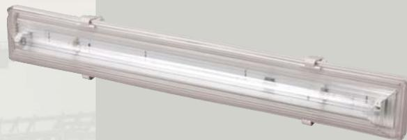
Светильники для установки люминесцентных ламп Т8, цоколем G13, мощностью 18, 36, 58 Вт (в зависимости от типоразмера) и степенью защиты от воздействия окружающей среды IP65 (пылевлагозащищенные).
