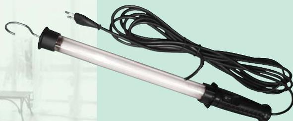
Светильник с люминесцентной лампой T5, цоколем G5, мощностью 8 Вт и степенью защиты от воздействия окружающей среды IP20, с выключателем на рукоятке, со шнуром питания, переносной.
