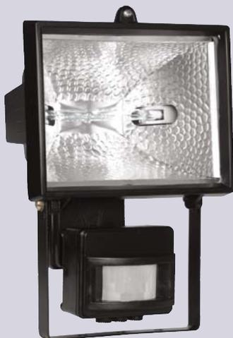
Прожекторы с датчиком движения, симметричным светораспределением, линейными галогенными лампами мощностью 150 Вт (ИО150Д) и 500 Вт (ИО500Д) с цоколем R7s и степенью защиты от окружающей среды IP54.
