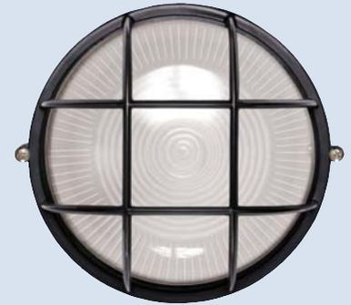
Светильники для ламп накаливания с цоколем E27 максимальной мощностью 60 Вт (НПБ 1302) и 100 Вт (НПБ 1102) и степенью защиты от воздействия окружающей среды IP44.
