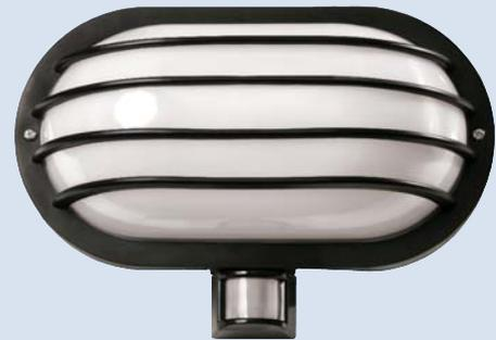
Светильник с детектором движения для лампы накаливания с цоколем E27 максимальной мощностью 40 Вт и степенью защиты от воздействия окружающей среды IP33.
