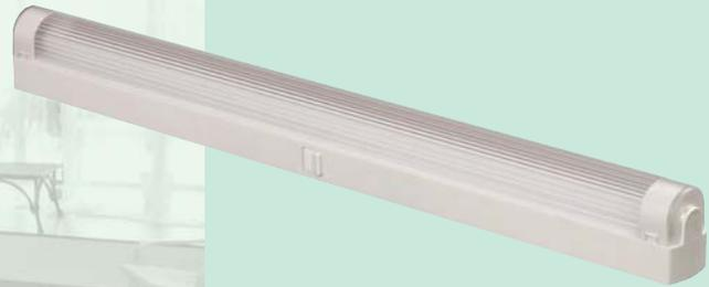
Светильник с люминесцентной лампой Т5, цоколем G5, мощностью 8, 13 Вт (в зависимости от типоразмера) и степенью защиты от воздействия окружающей среды IP20.
