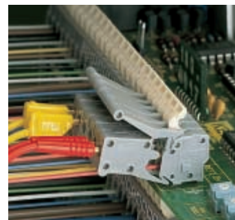
Проверка испытательным адаптером, серии 255, 256 и 257
