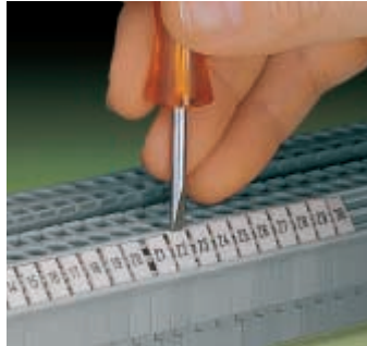
Закрепление полоски в маркировочных гнездах
