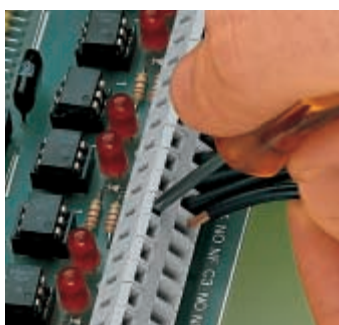
Подсоединение проводника „фронтальный электромонтаж“, серия 236
