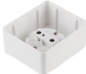
Изделия IP54 также монтируются при помощи саморезов. При этом подвод кабеля осуществляется через герметичную вставку. На тыльной стороне изделий нанесена схема разметки для случаев монтажа изделий на кирпичную или бетонную стену. Корпуса оснащены заземляющей клеммой.
