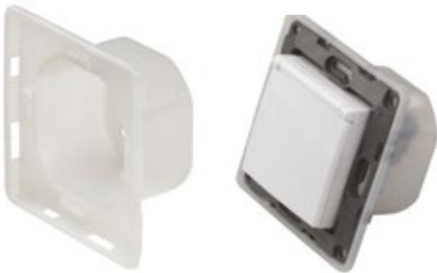
Защитный чехол применяется в случае необходимости установки розеток с крышками во влажные помещения, обеспечивая изделиям степень защиты IP44. При установке группы розеток с крышками в многоместные рамки стыкующиеся края чехлов обрезаются.
