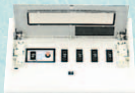
АНВ-NS Щит распределительный на 4 линии. Входной автомат - 30 А с УЗО. Ширина/высота/глубина 280x210x26мм.
